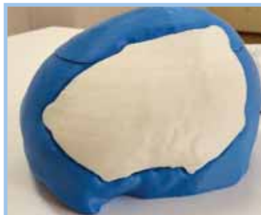
Рис. 2. Макет черепа напечатан на 3D-принтере FDM; белым цветом напечатана зона костного дефекта, по которой будет изготавливаться титановый трансплантат
